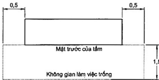
Hình 10 - Khoảng hở nhỏ nhất đến vỏ bao bọc
